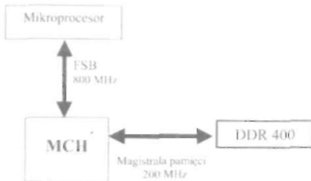
Rysunek 2.52. Klasyczny sposób komunikacji pamięci z procesorem
