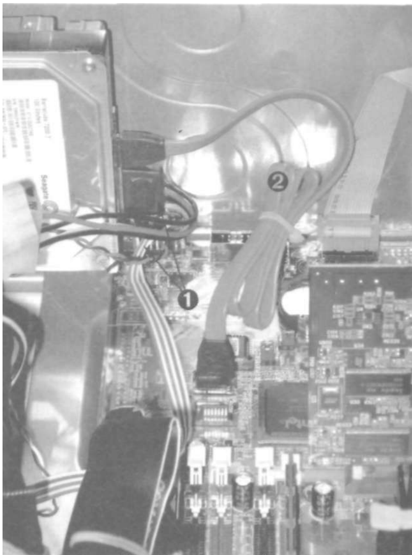
Rysunek 6.43. Sposób podłączenia dysku twardego SATA
