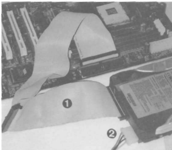
Rysunek 6.38. Sposób podłączenia dysku twardego
