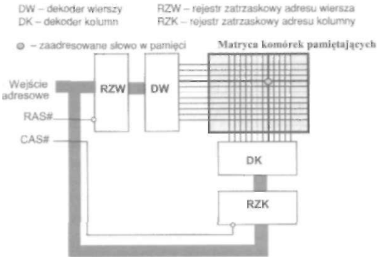
Rysunek 2.42b. Sposób adresowania słowa w pamięciach DRAM
